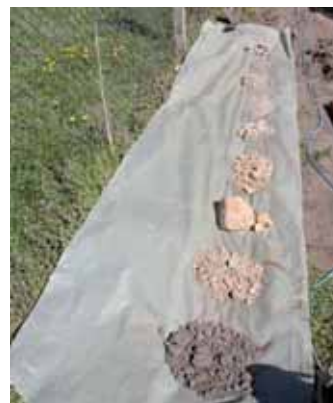
Anhand der bei der Bohrung gewonnenen Gesteinsproben kann die Wärmeentzugsleistung genauer ermittelt werden Quelle: LBGR – N. Schlaak
