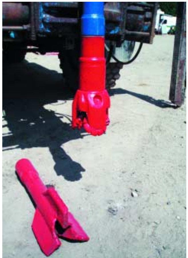
Abbildung 12 und 13: Bohrgerät (links) und Bohrkopf (Flügelmeißel und Rollenmeißel, rechts)
